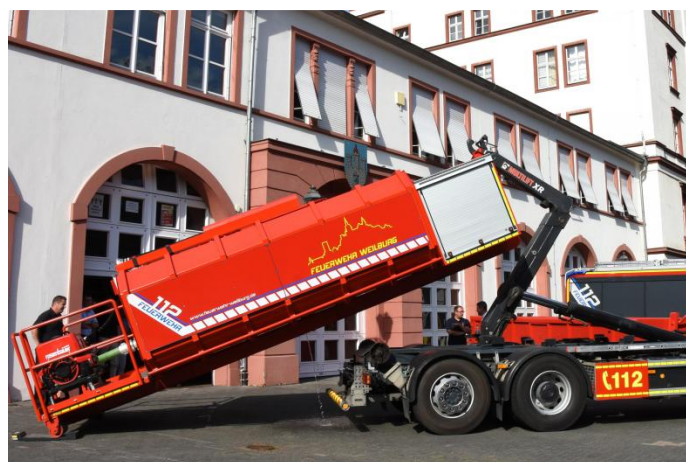
So funktioniert das Wechseln der Ladung: der Wassertank wird mittels Multilift abgestellt, so dass beispielsweise ein Container aufgeladen werden kann. Foto: Margit Bach
